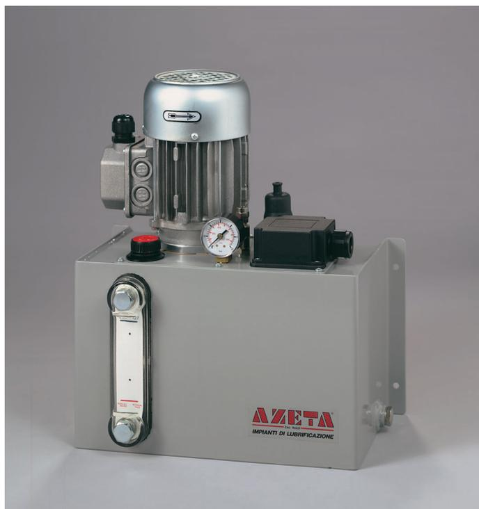
Il corretto funzionamento corrisponde alla continua rotazione pompa, alla pressione di linea costante ed al continuo recupero dell'olio eccedente, di ritorno nel serbatoio, per mezzo del foro posto al centro della vite di regolazione della valvola di By-pass.
