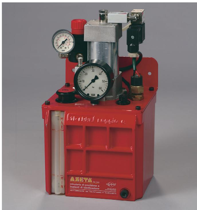
Comandando l'elettrovalvola 3/2 il cilindro pneumatico esercita la sua spinta sul pistone con pattino, che a sua volta comprime il lubrificante presente nella camera volumetrica fino allo spegnimento, quindi la camera inferiore del cilindro scarica la differenza di pressione per mezzo del reliving.
