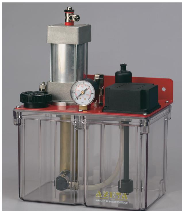
Al termine del comando si inverte il senso di spinta del cilindro pneumatico sollevando il pistone con pattino, che a sua volta riempie la camera volumetrica di lubrificante.
