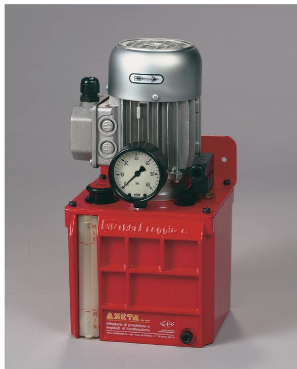
Il corretto funzionamento corrisponde alla continua rotazione pompa, alla pressione di linea costante ed al continuo recupero dell'olio eccedente, di ritorno nel serbatoio, per mezzo del foro posto al centro della vite di regolazione della valvola di By-pass.
